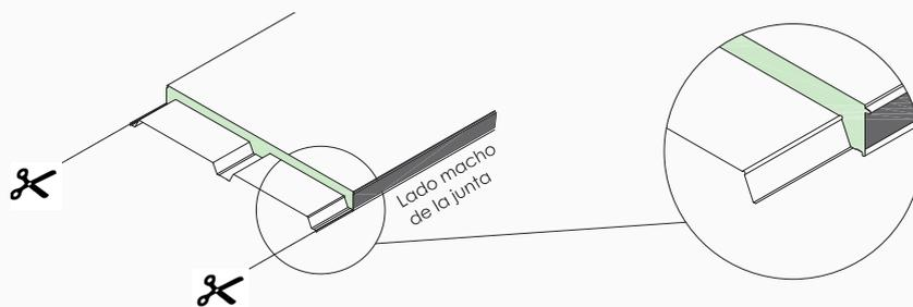
**5.** Aplicar un doble sellado con butilo en la zona de solape del panel inferior, limpiando y secando previamente la superficie.
