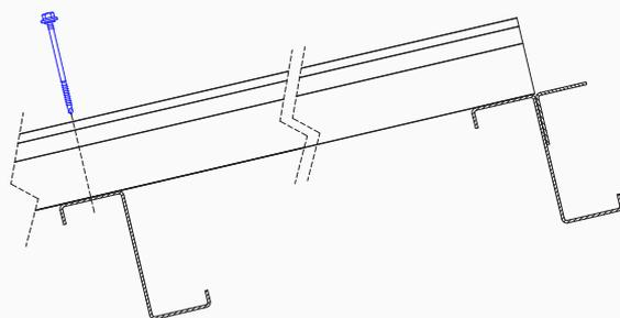
**3.** Eliminar la chapa interior (precortada) y la espuma del panel que va con el corte de solape (panel superior).
