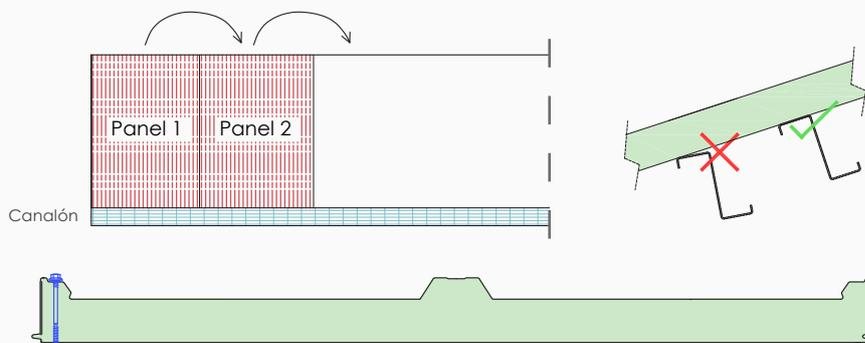
4. Colocar el segundo panel, respetando el machihembrado. Para un encaje más fácil, el panel debe entrarse con una leve inclinación.
