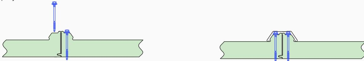
6. Proceder de igual forma con el resto de la cubierta, controlando en todo momento la alineación entre paneles y la alineación de los paneles con la estructura.
