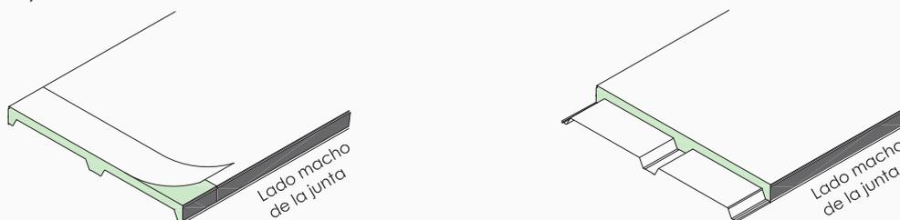
**4.** Cortar los bordes laterales del solape y extraer la chapa sobrante.
