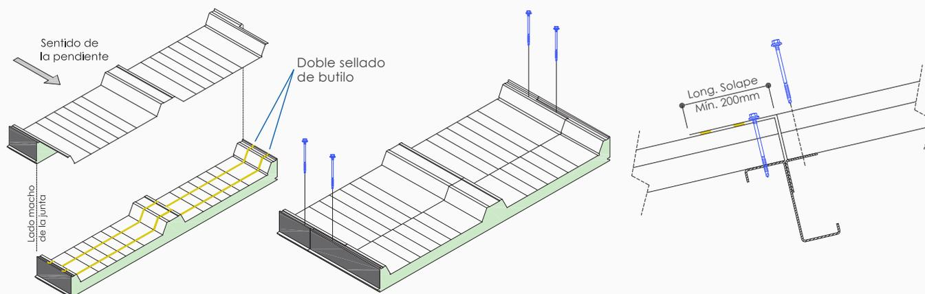
7. Coser con 2 o 3 tornillos por valle (en rojo en el dibujo) la chapa del solape con el panel inferior.
